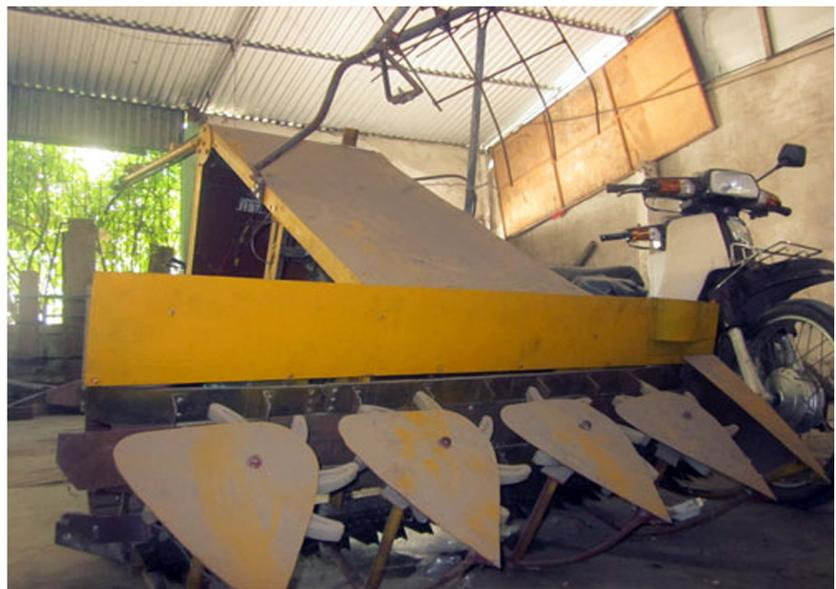
*Chiếc máy gặt làm từ động cơ xe máy Dream, có chi phí 7 triệu, năng suất 10phút /sào.*
