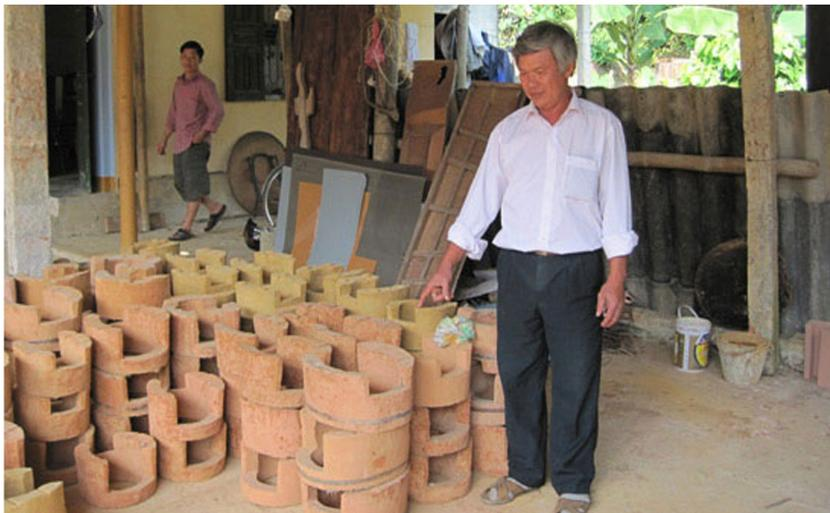
Bếp TK90 có nguyên lý hoạt động đơn giản, nhưng lại có tác dụng lớn trong việc tiết kiệm chất đốt, đồng thời giảm tối đa lượng khí thải độc hại, khói, bụi ra môi trường; tiết kiệm từ 50-70% chất đốt so với bếp thường. Mỗi chiếc bếp có giá thành từ 150.000 - 250.000 đồng, có độ bền 3-5 năm. Với giá thành hợp lý như vậy, mỗi gia đình đều có thể mua một chiếc bếp phục vụ sinh hoạt.
