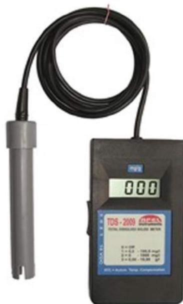
Với đặc điểm vỏ hộp được làm từ plastic màu đen, có thể sử dụng trong môi trường có hơi dung môi hay dầu. Ứng dụng đo độ dẫn điện các dung dịch, đánh giá chất lượng nước ngầm, nước cất, nước xử lý bằng trao đổi ion, nước dùng trong công nghệ xi mạ, nuôi trồng thủy sản, chế biến thực phẩm, nước sinh hoạt, nước thải...
