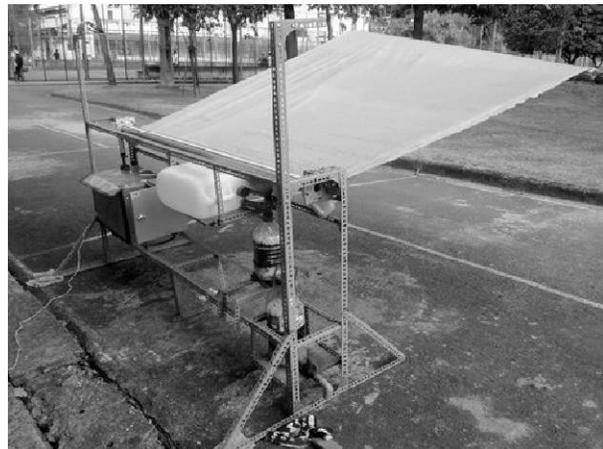
Hệ thống thu và xử lý nước mưa tự động
