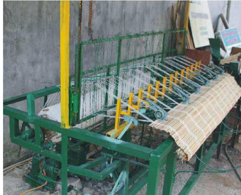
Hình ảnh giải pháp công nghệ - Máy dệt mành cọ
