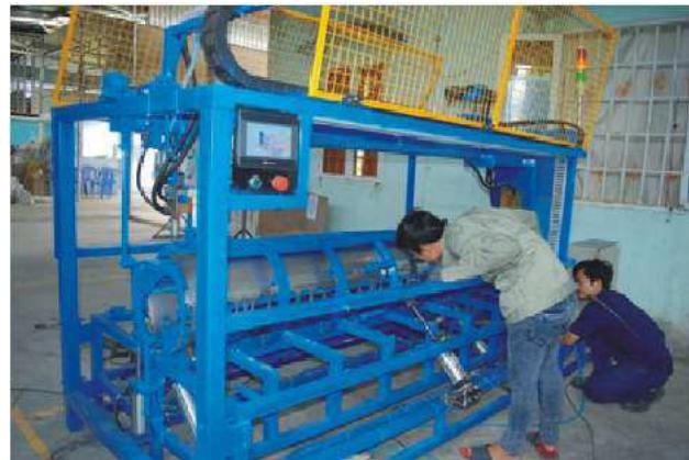
Hình ảnh máy hàn bình bảo ôn tự động
