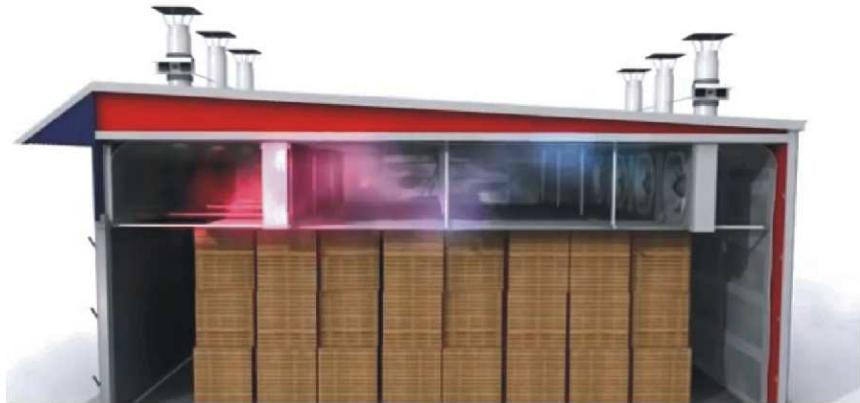
Hình ảnh máy sấy gỗ bằng năng lượng mặt trời
