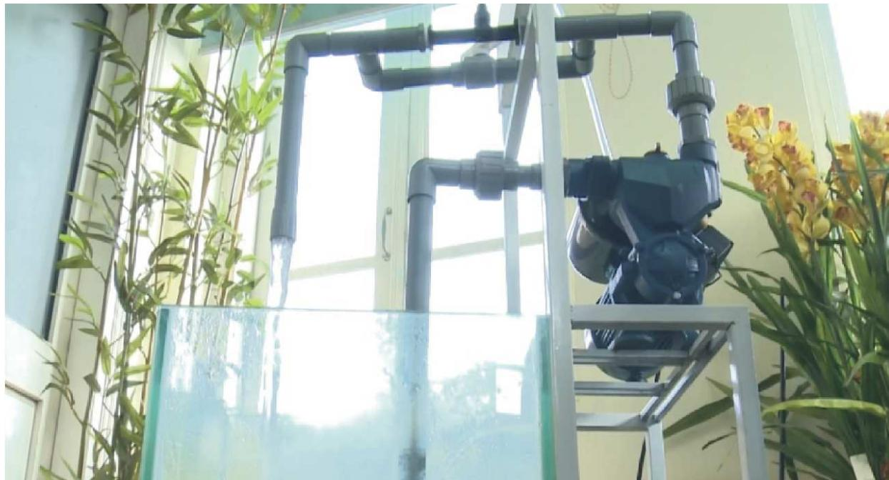
Hình ảnh máy bơm nước Ozone diệt khuẩn
