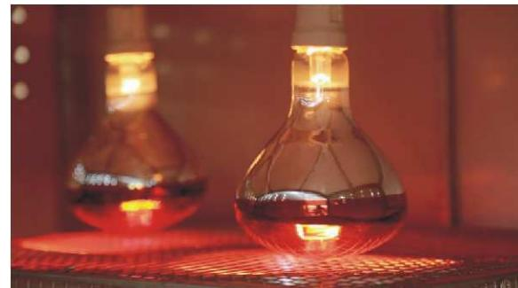
Hình ảnh bóng đèn chiếu tia hồng ngoại trong hệ thống sấy hồ tiêu
