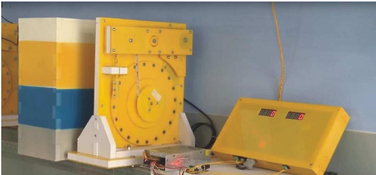
Hình ảnh: Thiết bị đo mực nước tự động
